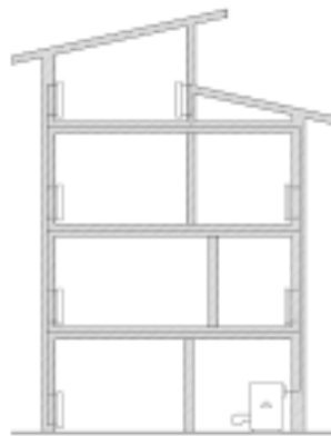
Figura I - Sistema edificio-impianto costituito da un unico edificio servito da un unico generatore
