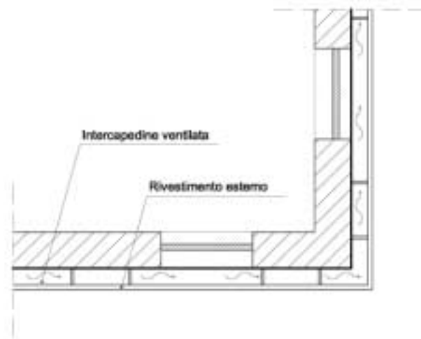
Figura IV - Definizione della superficie lorda climatizzata in presenza di intercapedine ventilata
